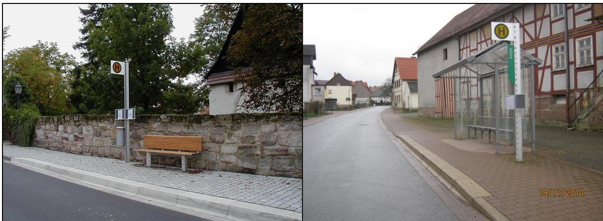
Abb. II-17: Beispiele für Bushaltestellen mit Hochborde: Bad Sooden-Allendorf Hospitalkapelle (links) und Hessisch Lichtenau-Quentel Mitte (rechts)
