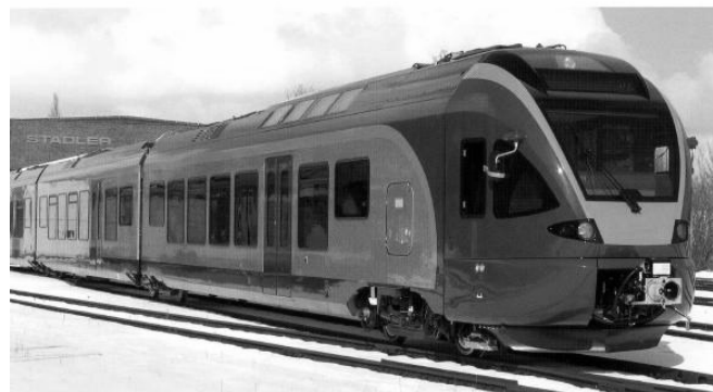
Elektrischer Niederflurtriebzug FLIRT für die Cantus Verkehrsgesellschaft mbH
